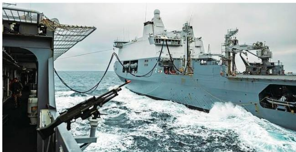
Een zogeheten RAS (Replenishment At Sea) wordt geoefend: het bevoorraden van een schip op zee.
