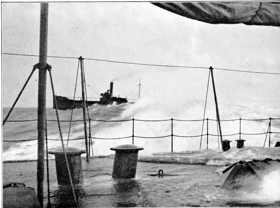
Achterschip Hr. Ms. „Java“, stoomende met vol vermogen op ongeveer 10 Meter waterdiepte.
