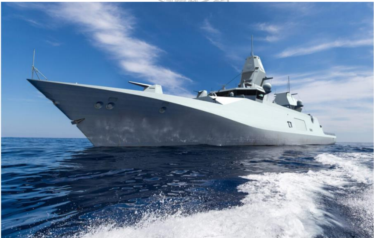
De fregatten worden 145 meter lang en 18 meter breed. Ze krijgen een diepgang van 5,5 meter bij een waterverplaatsing van 6400 ton.
