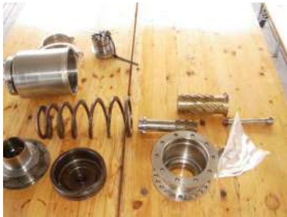
Startmotor na demontage
