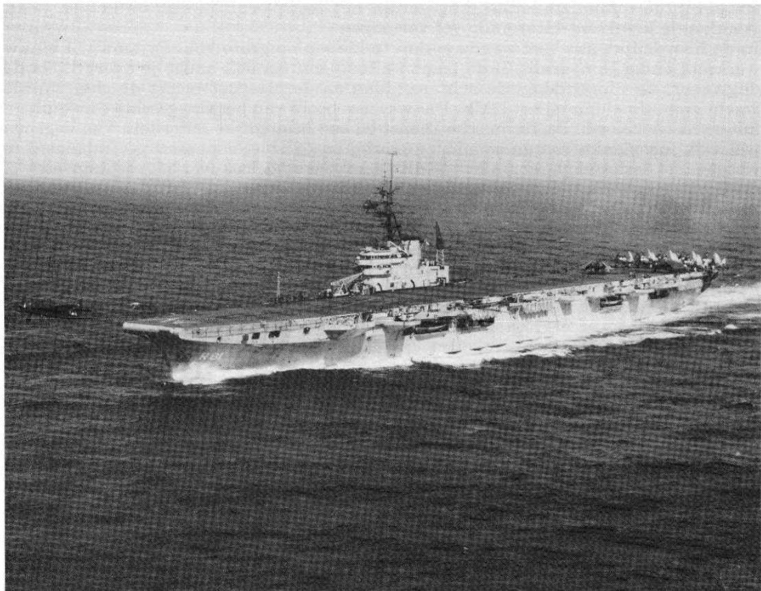
Hr.Ms. Vliegkampschip Karel Doorman. Twee units, elk met twee ketels en één turbine-installatie. Maximaal vermogen 40.000 APK. Stoomkatapult. Maximum snelheid 25 mijl. In dienst geweest van 1948 tot 1968.
