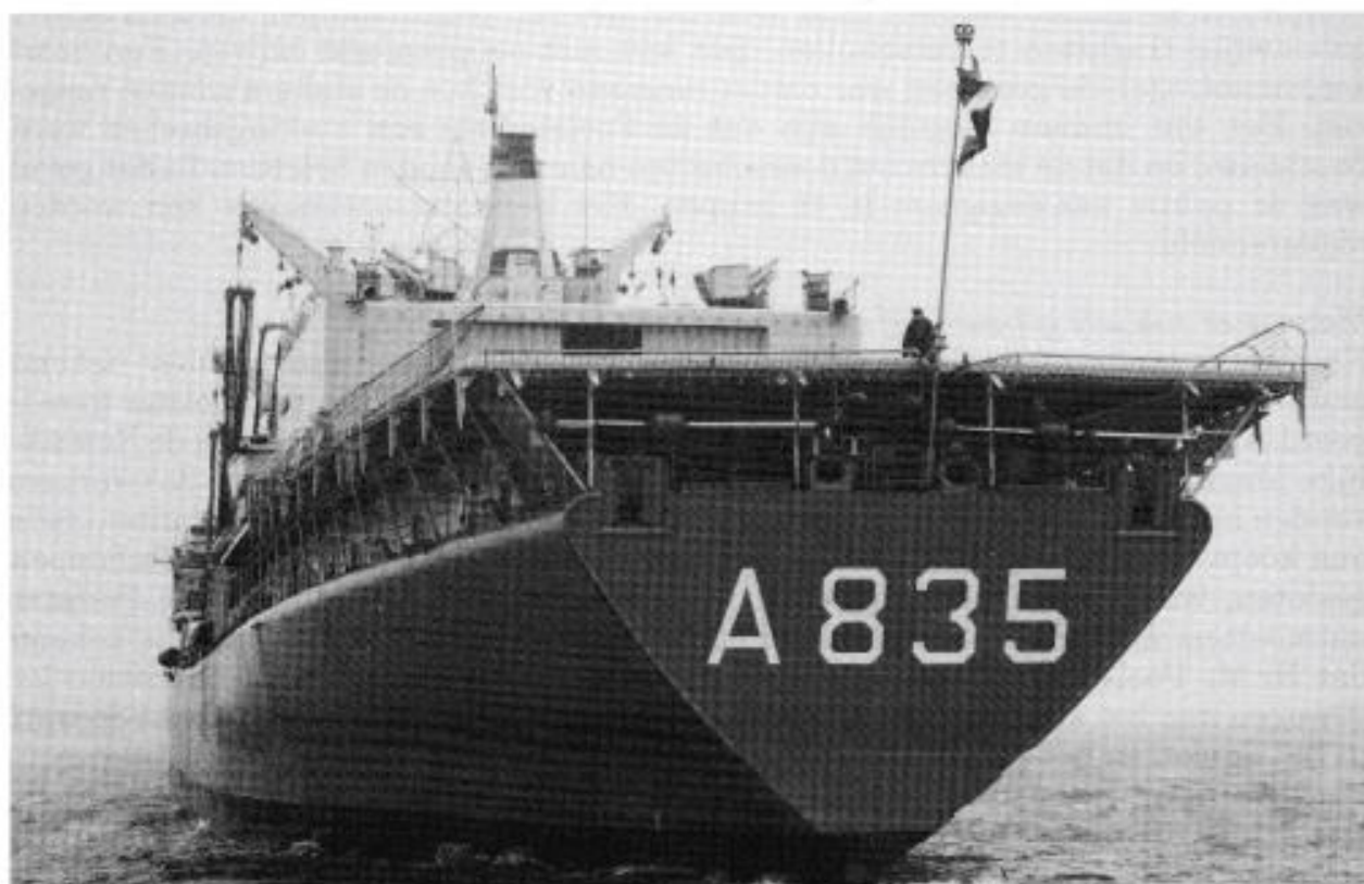
Hr.Ms. bevoorradingschip Poolster. Twee Forster Wheeler ketels. Een Pamatrada turbine-installatie. Vermogen 22.500 APK. 1 schroef. Maximum snelheid 21 mijl. Het laatste stoomschip wordt uitgezwaaid.
