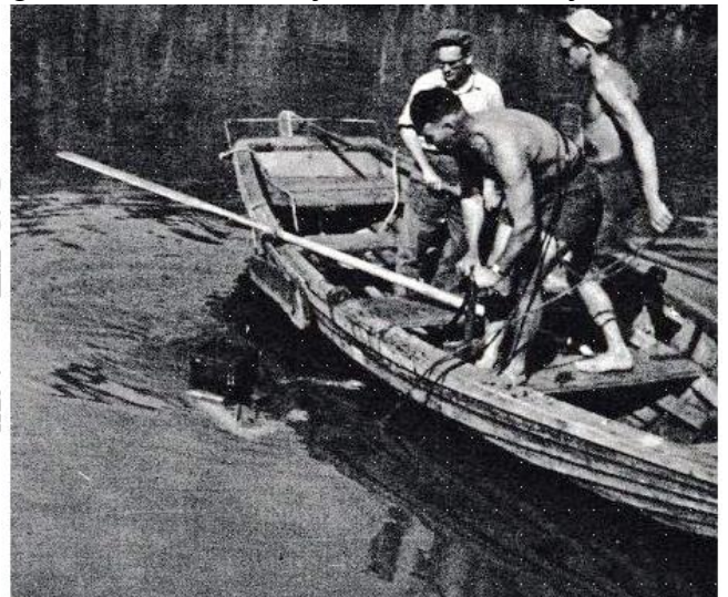
DUIKERKLOK van een oud benzineblik, een fietspomp en een paar stukjes luchtslang. Ze blijven er tientallen minuten mee in zeven-meter diep water om Japanse vliegtuigbommen op te duiken.
