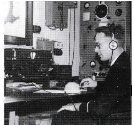
Midden jaren '50. Marconist A. Pothoven aan het werk. Communicatieapparatuur van Philips NSF: twee ontvangers (de BC-348 en de H3L7U) en twee zenders (de middengolfzender MZ- 32 en de kortegolfzender MZ-33).
