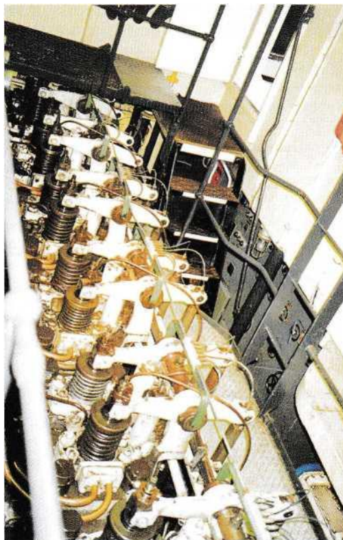
De uit 1951 daterende Smit/MAN diesel van de „Procyon”, nog steeds het betrouwbaar kloppend hart van het schip. Foto Albert Boes.
