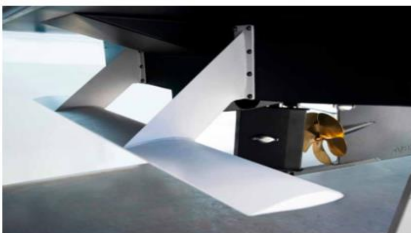
De Hull Vane wordt bevestigd onder het schip en werkt als een surfplank: deze heeft profijt van een opgaande waterstroom. (Hull Vane BV)
